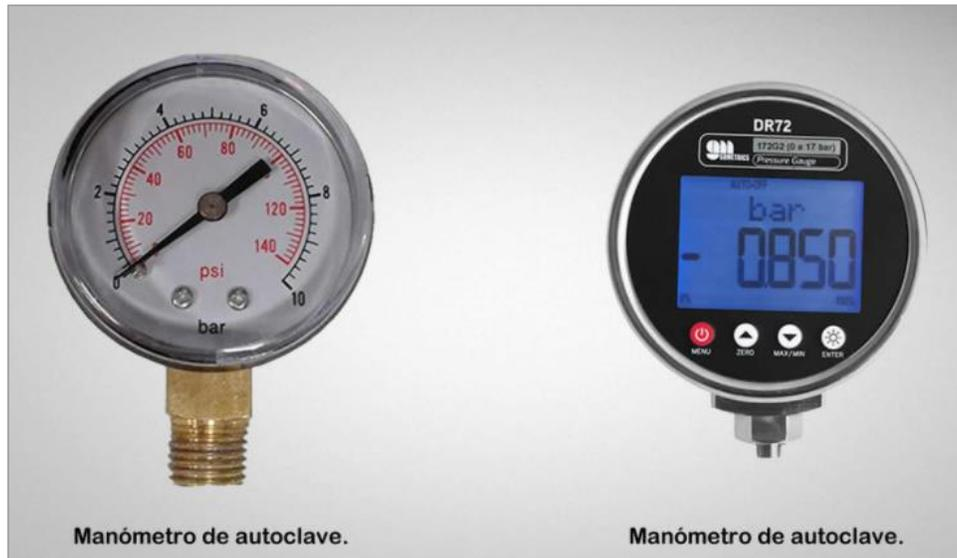
Debe ser de tipo Bourdon y tener la capacidad para indicar la presión máxima de trabajo del autoclave, procurando que dicha se presión se encuentre en el tercio central de la graduación de la esfera; una línea roja indeleble, marca la presión máxima de trabajo.
